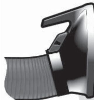
شکل ۳- تهویه موضعی و روش صحیح استقرار آن. هود موضعی در حالت افقی دارای بیشترین راندمان است.
